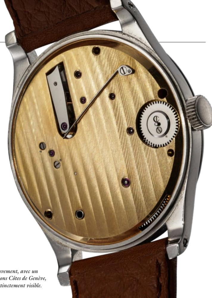
Vue arrière du mouvement, avec un large pont en Or, finitions Côtes de Genève, et ressort d'égalité distinctement visible.
