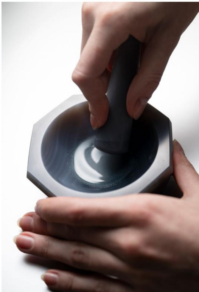
*Préparation de l'émail: L'émail est broyé finement dans un mortier avec de l'eau pour obtenir une pâte homogène, prête à être appliquée sur le cadran.*
