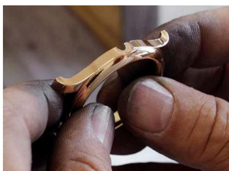
Polishing of a Chronomètre Optimum case.
