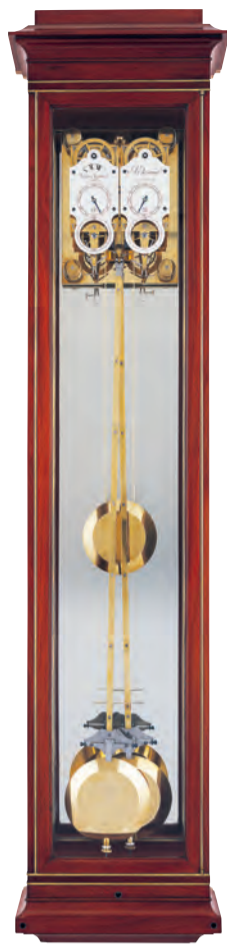
2 2 nd Double pendulum regulateur Antide Janvier, circa 1780 Collection Montres Journe SA, Geneva
