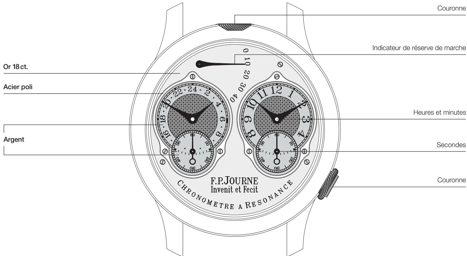
Les cadrans des heures en argent massif sont maintenus par un cerclage en acier poli, vissé\* sur le cadran en or 18 ct.
